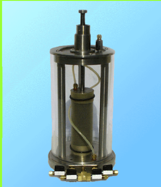
آزمایش سه محوری Triaxial Test
